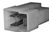
Der 3-pol. Stecker mit roter, gelber und schwarzer Leitung ist für den Anschluss der Steckdosenpole 9 (Dauerplus 30), 10 (Ladeleitung) und 11 (Masse Stromkreis 10) vorgesehen.
